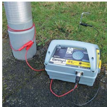
Способ трассировки кабелей малого диаметра
