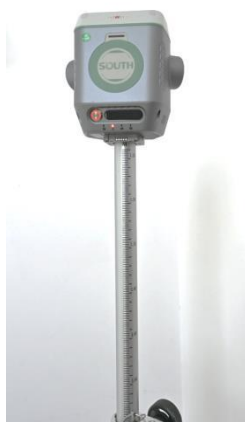
Прибор на вехе (для небольших сканирований)
